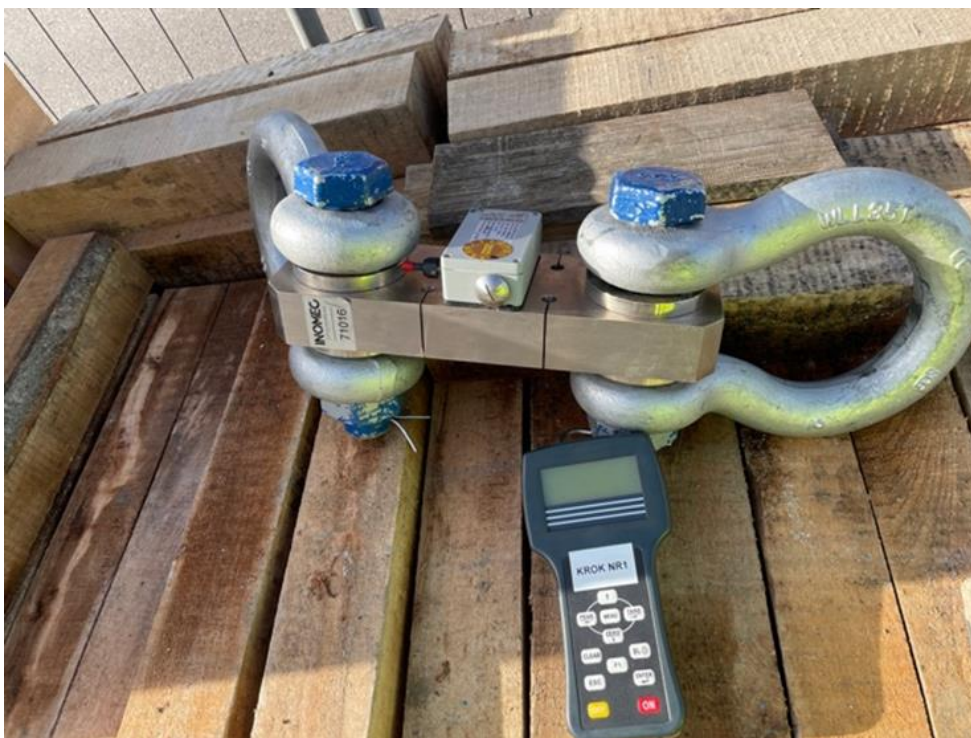
Figur 6. Lastsensor monterad på lyftöglor med trådlös avläsning.
